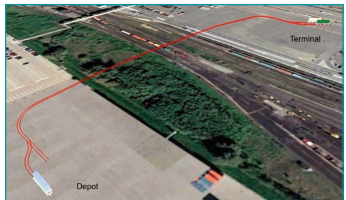
Bild 3: ContainerRailCab-Anlage für die Depot-Anbindung im EUROGATE CTH. Quelle Satellitenbild: Google Maps
