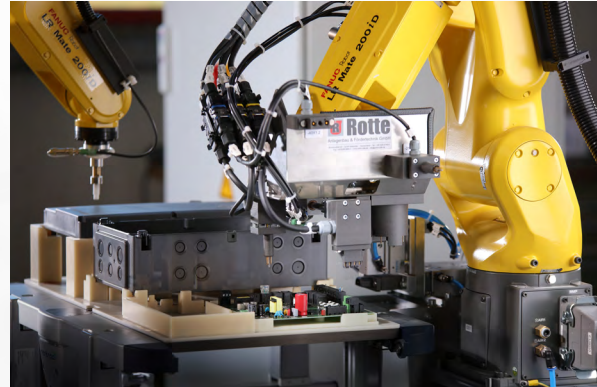
Funktionsprüfung von Steuerungsgehäusen
