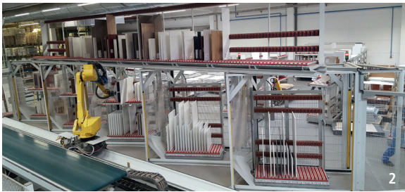
>Oben: Egal ob automatisierte Griffleistenmontage (3 & 4), automatische Kommissionierung von Fronten und Korpusteilen (2) oder automatisierte Schubkastenmontage (1): Roboterzellen ermöglichen gänzlich neue Prozesse. Unten: Das „Smart Factory Panel“ von Ulrich Rotte.
