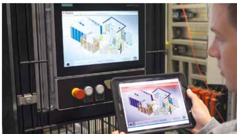
Das Bediener-Assistenzsystem Smart-Factory-Panel ermöglicht eine einfache Anlagensteuerung.
