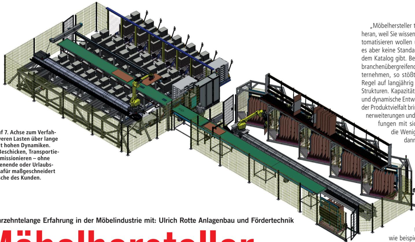
>Roboter auf 7. Achse zum Verfahren von schweren Lasten über lange Distanzen mit hohen Dynamiken. Entstackeln, Beschicken, Transportieren und Kommissionieren – ohne Pause, Wochenende oder Urlaubsansprüche, dafür maßgeschneidert auf die Wünsche des Kunden.
