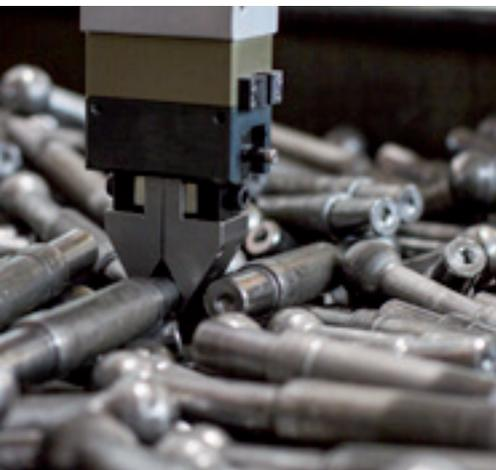
Je nach Anforderungen der Weiterverarbeitung überprüfen wir die herausgegriffenen Teile in einem nachgeschalteten Visionprozess bezüglich Lage und Qualität. Diese Überprüfung des Greifergebnisses dient der Prozessabsicherung bei der Beschickung von Folgeprozessen, Greifergebnisse außerhalb der Toleranz führen zum Aussortieren bzw. zur Rücklagerung in das Schüttgut.
