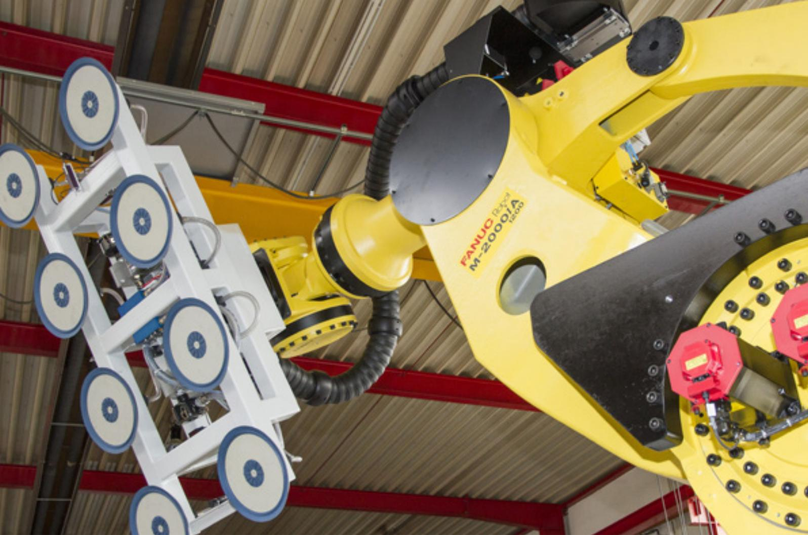
**Greifen mit Lageerkennung** gestattet die Lokalisierung der Werkstücke durch Kamertechnik, lagespezifisches Greifen ohne vorherige Ausrichtung, Erkennen und Aussortieren der zu greifenden Werkstücke nach Qualitätsmerkmalen bzw. nach Produkttypenmerkmalen.
